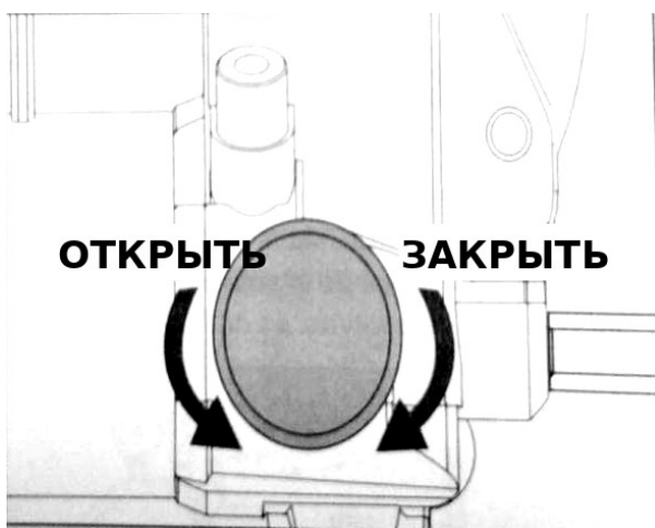
Рис. 2. Клапан сброса давления: направления открытия и закрытия
